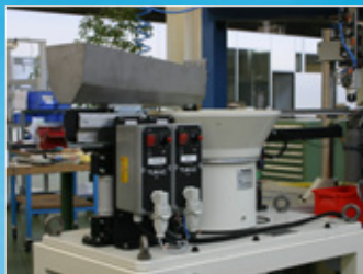
Alimentation automatique des pièces par bol vibrant
